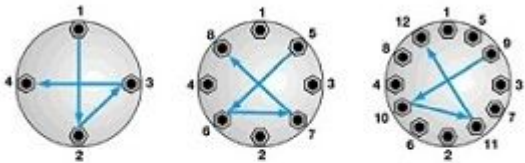
Corretta sequenza di serraggio
