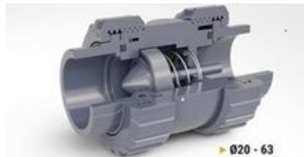
Il nuovo otturatore di chiusura, con sistema di guida ad albero interno garantisce una perfetta linearità di movimento. Nel corpo è stato incorporato un dispositivo di centraggio per guidare l'albero, evitando le oscillazioni generate dalle turbolenze del fluido
