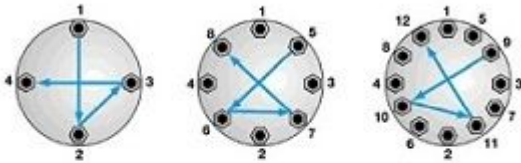
Corretta sequenza di serraggio
