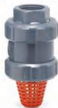
1761 VALVOLA DI FONDO con succhieruola con otturatore a molla filettata femmina
