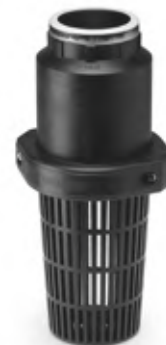
1761 VALVOLA DI FONDO con succhieruola con otturatore a molla filettata femmina
