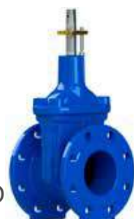
25660AP SARACINESCA CORPO PIATTO a cuneo gommato PN10/16 con indicatore di apertura
