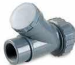
1802 VALVOLA DI NON RITORNO A Y con otturatore a sfera filettata femmina
