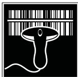
Il codice a barre o QR presente sulla maggior parte dei raccordi per elettrofusione disponibili sul mercato contiene tutti i dati necessari per la saldatura. Una volta effettuata la scansione, questi dati vengono trasferiti automaticamente alla saldatrice e valutati. Il codice contiene essenzialmente i seguenti dati: produttore, tipo, diametro, tensione di fusione, tempo di fusione (con correzione della temperatura, se applicabile), resistenza e tolleranza di resistenza.
