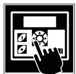
Se non è disponibile un codice a barre, è possibile inserire manualmente i parametri di saldatura forniti dal produttore del raccordo (come tensione e tempo).
