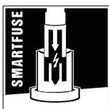
Leggendo la resistenza di riferimento in uno dei pin dei connettori del raccordo SmartFuse, la saldatrice per elettrofusione determina automaticamente i parametri di saldatura per il raccordo.
