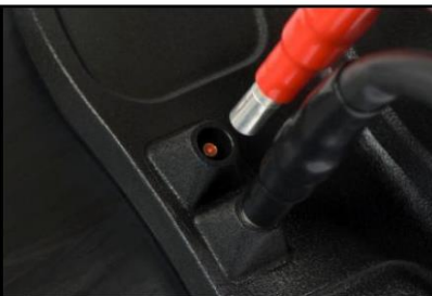
FASE 4: Collegamento ai terminali della saldatrice con impostazione dei parametri di saldatura mediante riconoscimento automatico o penna ottica e saldatura
