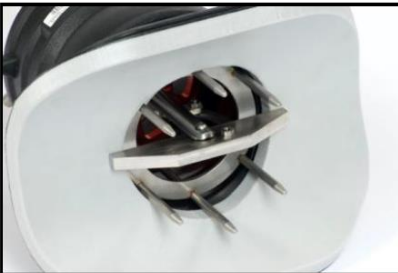
FASE 3: Inserimento sella orientabile in apposito utensile e bloccaggio sulla tubazione
