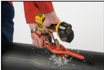
FASE 2: Foratura con apposito utensile e pulizia della superficie della tubazione
