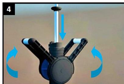
Con le leve in posizione sollevata, premere l'albero per portare la fresa a contatto con il tubo.
