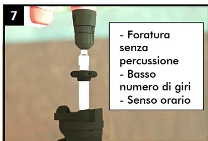
Preparare il trapano a batteria in modalità di perforazione, senza percussione, avviando la rotazione in senso orario con un basso numero di giri. Per tubi molto spessi, si consiglia di utilizzare batterie ad alta intensità Tipo 8Ah/12Ah.
